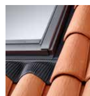
Lemovanie EDW Vysokoprofilovaná strešná krytina do 120 mm
